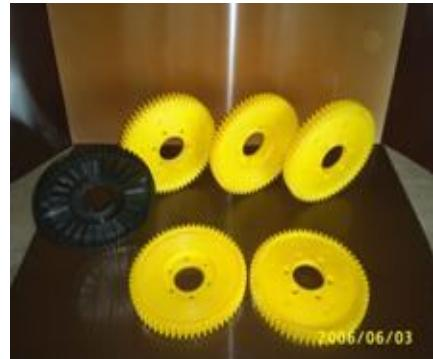
Finalni delovi napravljeni od **KOMPOZITNIH, POLIAMIDNIH i POLIETILENSKIH** materijala.
