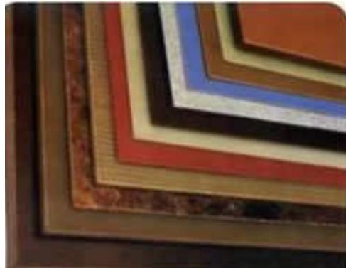
Tehnički laminati se proizvode u obliku ploča, cevi i štapova i to : Na bazi fenolnih smola; Hartija - **PERTINAKS**; Pamučnog platna - **TEKSTOLIT**; Na bazi epoksidnih smola istaklenog vlakna - **STAKLOLIT**; Na bazi liskuna- **MIKANIT**; Na bazi bukovog drveta – **VODOOTPORA ŠPER PLOČA**.
